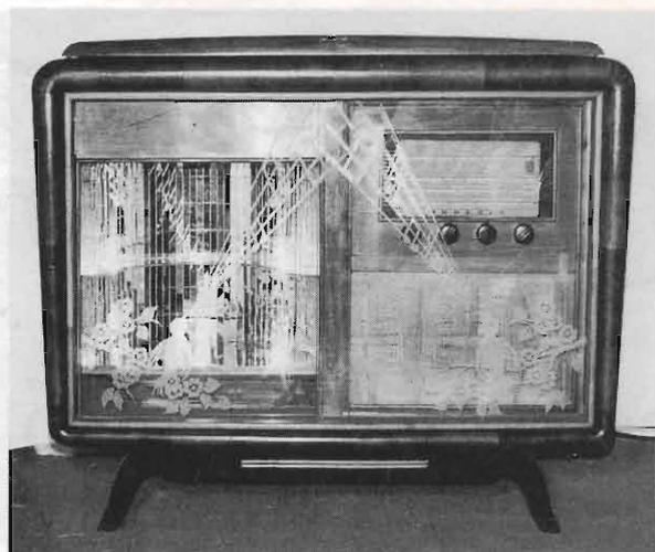
Foto 9 - Il mobile a vetri montati: notare il disegno che riproduce una coppia di uccellini intenti a cantare "La cucaracha". A destra si intravede la tela coprialtoparlante tessuta in rilievo con del carice, un'erba palustre tutt'ora utilizzata per impagliare le seggiole.
